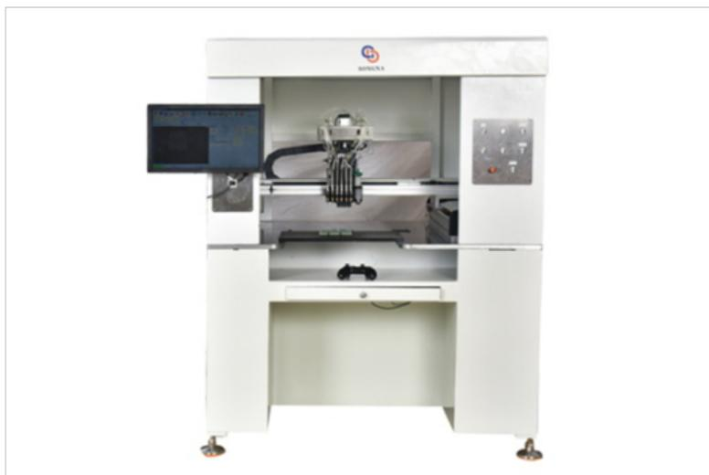
硅胶上色机是一种由单片机控制，非接触式喷墨标识系统。其通过控制内部齿轮泵或由机器外部供应压缩气体，向系统内墨水施加一定压力，使墨水经由一个几十微米孔径喷嘴射出。并由加在喷嘴上方晶体振荡信号将射出连续墨线分裂成频率相同，大小相等，间距一定的墨滴，然后，墨滴在经过充电电极时被分别充电，其所带电量大小由中心处理器CPU进行控制；再经过检测电极检测墨滴实际所带电量与相位是否正确；较后，带电墨滴在偏转电极形成偏转电场中发生偏转，从喷头处射出，分别打在产品表面不同位置，形成所需各种文字，图案等标识。
